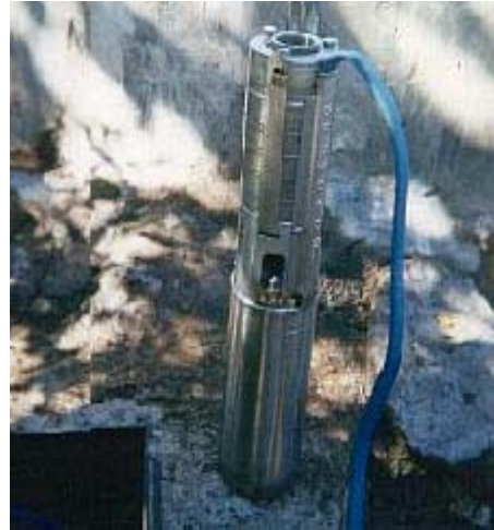
Figura 4. Bomba centrífuga sumergible (Grundfos)
