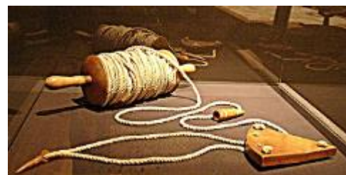
Figura 4. Corredera para medir la velocidad del barco
