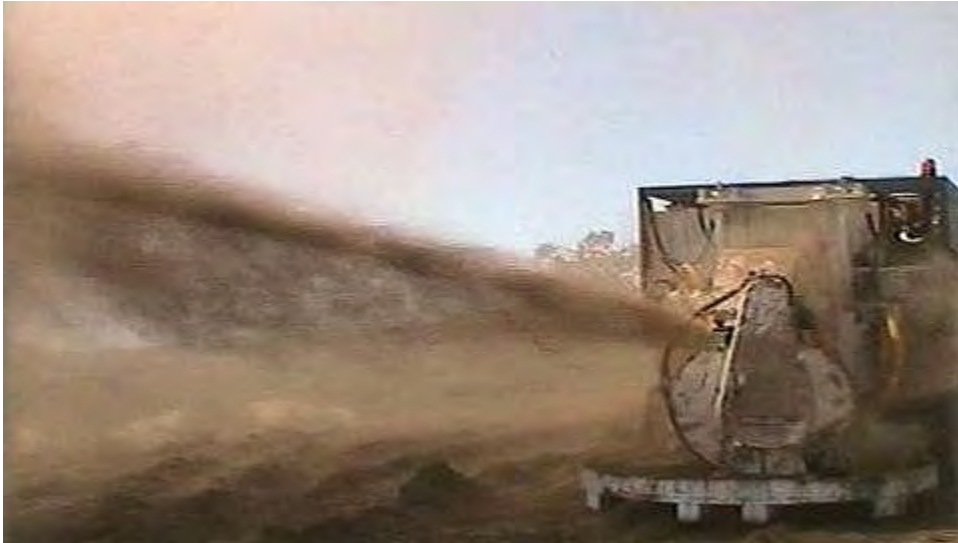
Robot Motobomba lanzador de tierra contra fuego
