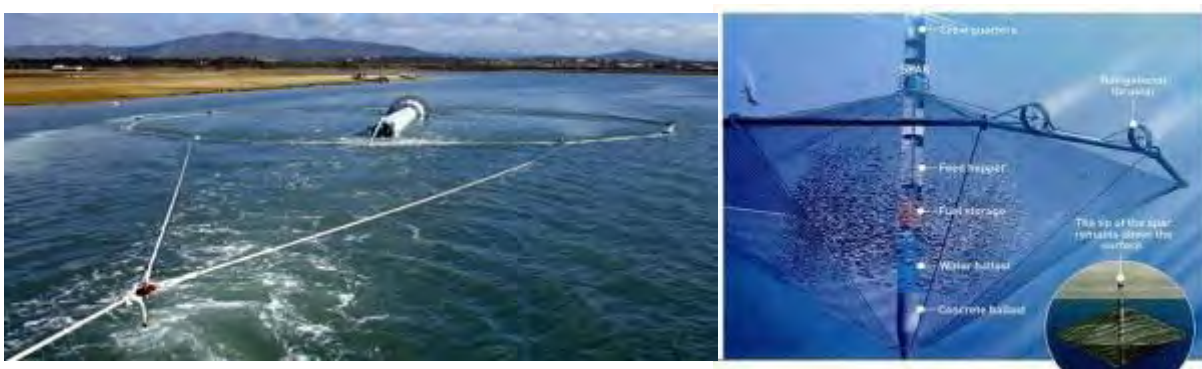
Figura 13. Estación marina SeaStation diseñada por Oceanspar . A la izquierda, la estación arrastrada hasta su destino final; a la derecha, la estación ya instalada.
