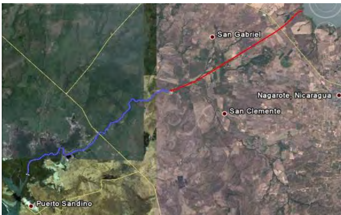
Foto aérea del istmo de El Tamarindo, 25 km, en la que se ha superpuesto, en rojo, el canal del desaguadero, y en azul, el curso del río Tamarindo.
