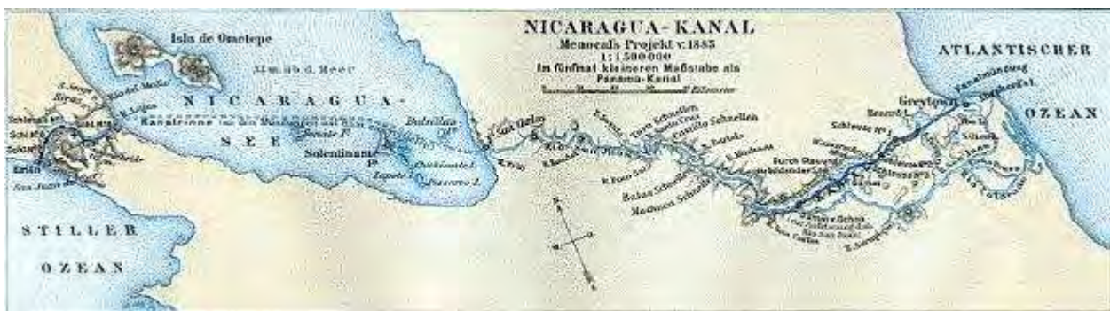
Ruta propuesta por Menocal en 1885. En azul oscuro las secciones excavadas del canal.
