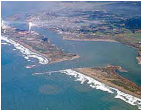
Vista aérea de los rompeolas a la entrada del Puerto de la Bahía de Humboldt. Los rompeolas mitigan las arenas de la barra garantizando la entrada al puerto.
