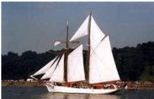
Figura 5: Un ejemplo de goleta como la San José , rebautizada Granda por Walker. Nótese que solo tiene velas de cuchillo.
