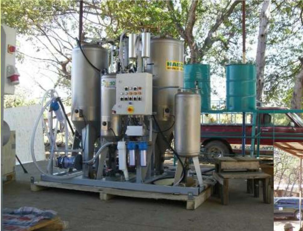
Instalación de planta para procesar aceite de higuierillo, jatropha, aceites vegetales usados para biocombustible (capacidad de 400 litros diarios)
