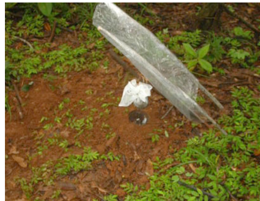
Trampa de foso con excrementos como cebo y techo plástico.
