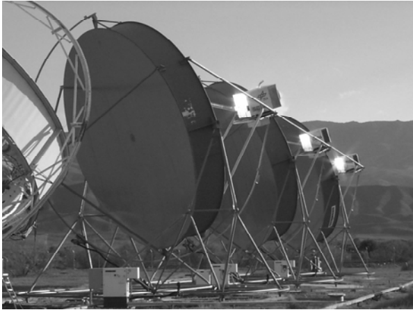
Figura 12. Vista lateral de las tres unidades DISTAL-II de la PSA, fabricadas por la empresa alemana Steinmüller y con el motor SOLO 161 solar en el año 1996. Cada unidad tiene un diámetro de 8,5 m y una potencia eléctrica bruta de 10 kW.
