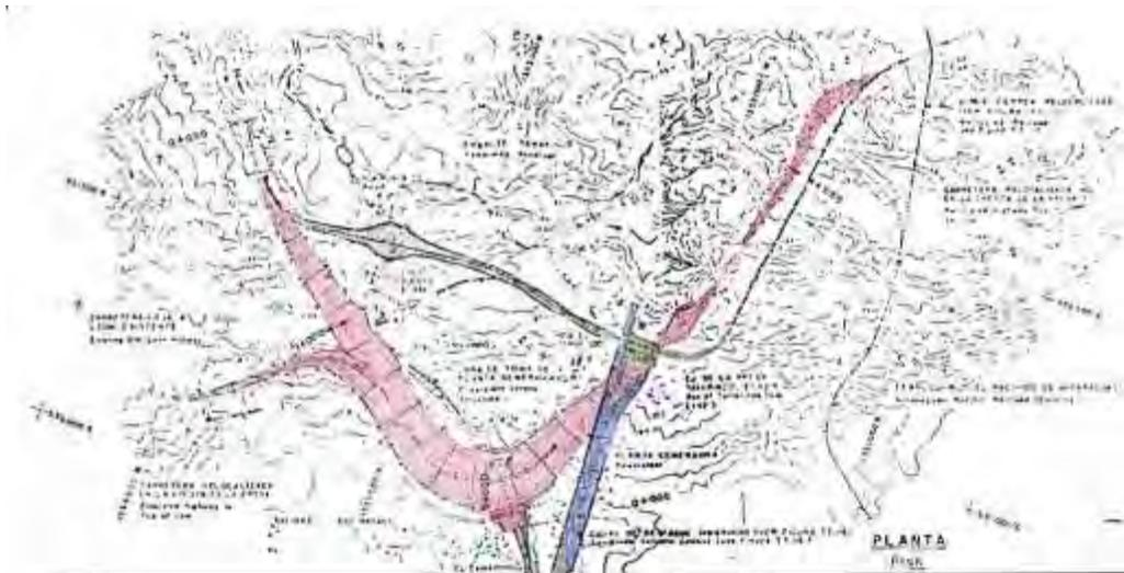
**Figura 11 – Alternativas del cambio de alineamiento de la carretera vieja a León, de la ubicación de la presa El Tamarindo y del tubo, o canal, de desfogue.**
