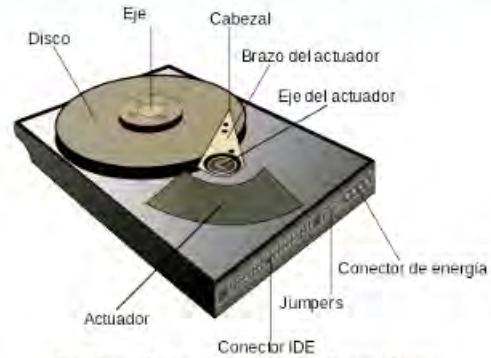
Partes de la unidad de disco duro.
