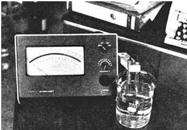
**Figura 23. Potenciómetro.**
