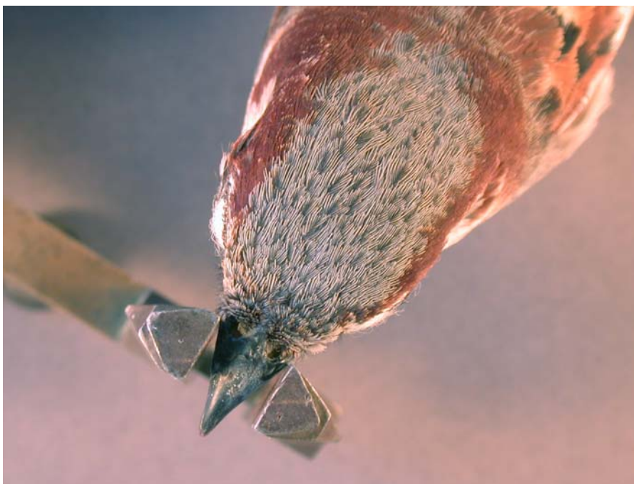
Figura 4. Los brazos del calibrador se cierran sobre la base del pico, justo en el punto donde el culmen se une a las plumas de la frente.
