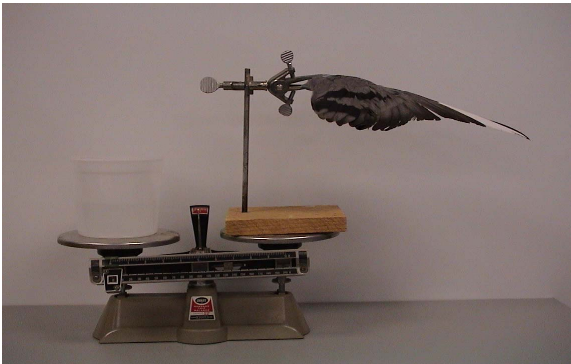
Figura 2. Ala montada en la báscula con peso igual en agua.
