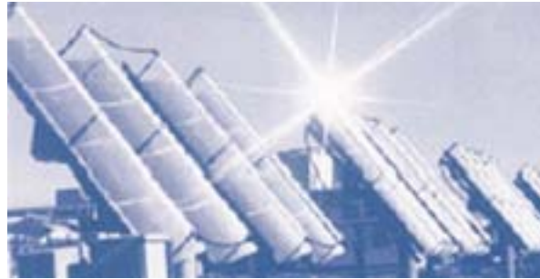
Figura 16. Sistema de espejos parabólicos para aplicaciones térmicas.
