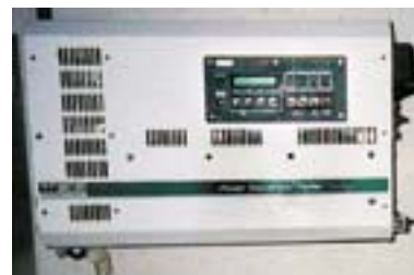
Figura 7. Convertidor de corriente directa a corriente alterna.
